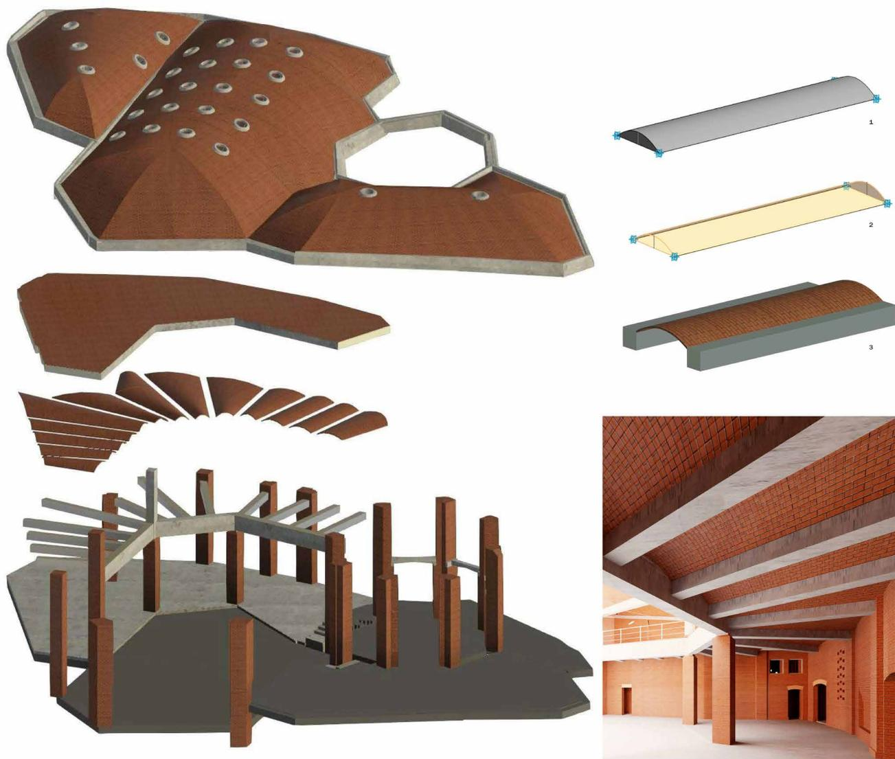
**Fig. 6** Axonométrico de las partes que conforman la estructura y las cubiertas abovedadas
