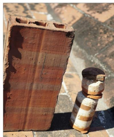
Fig. 5. Carotaggio sulla volta e composizione stratigrafica.
